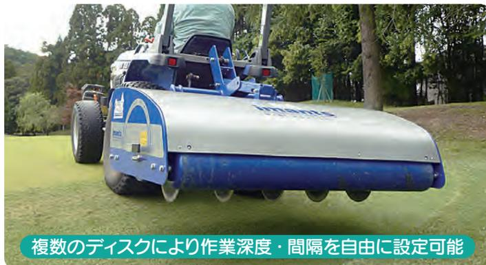
複数のディスクにより作業深度・間隔を自由に設定可能
