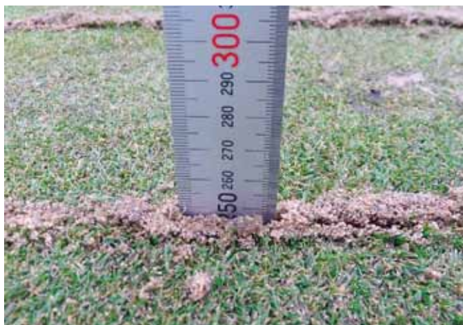
★最大深度250 mm。しっかりと排水溝を作り出します。
