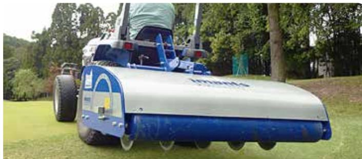
複数のディスクにより作業深度・間隔を自由に設定可能
