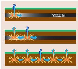
高圧エアが立体的に連絡し、効率的に土壌 の排水・通気・固結を改善します。
