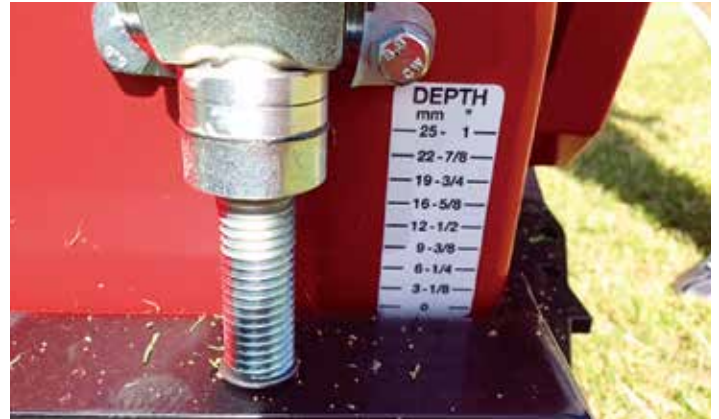
工具不要で深さ設定が可能。現場に応じて簡単に調整
