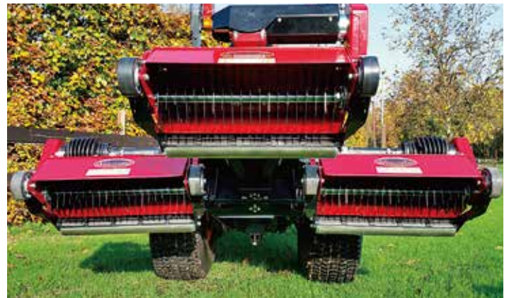
3連独立ユニットを採用しアンジュレーション追従性を確保
