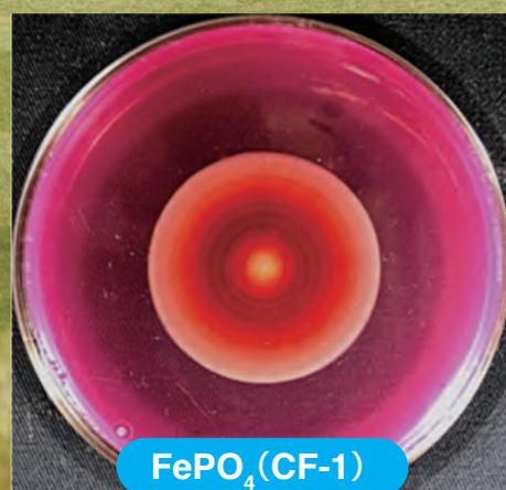
分解くんCF-1が不透明状の難溶性リンを溶解してクリアゾーンが出来ている様子。
