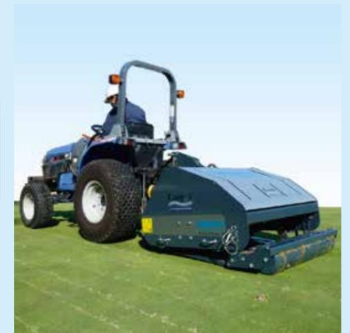
トラクター牽引式スリッピング式エアレーター
