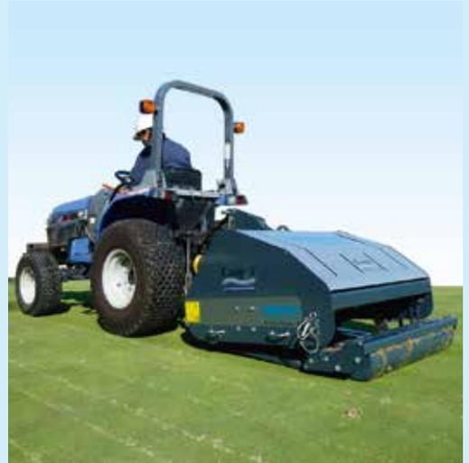
トラクター牽引式スリッピング式エアレーター
